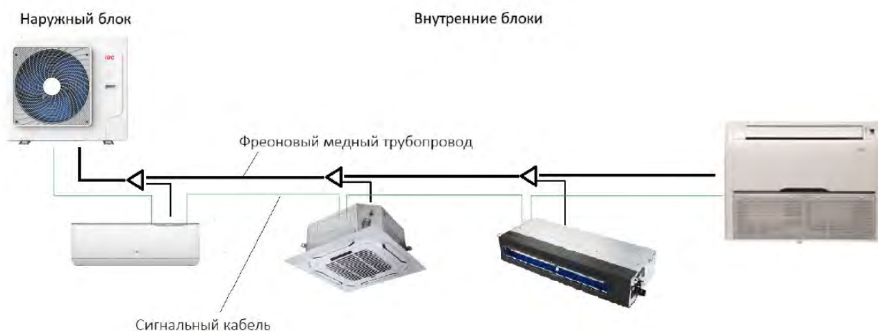
Рис.1.1- Состав мультизональной системы кондиционирования воздуха
